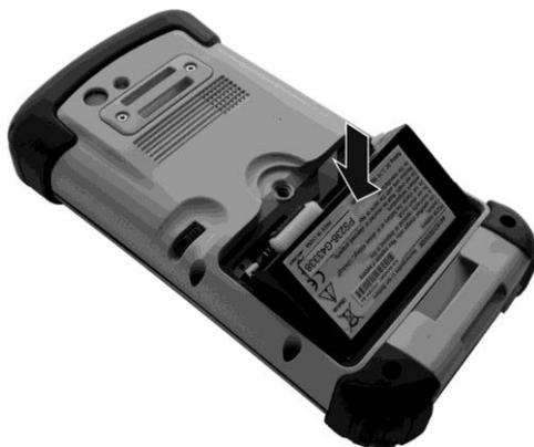
4. Insérez le bord inférieur du capot batterie en faisant un angle, puis, avec le loquet toujours en position de déverrouillage (à la verticale), remettez le loquet en position. Verrouillez le loquet en le faisant tourner dans le sens des aiguilles d'une montre pour le mettre en position verrouillée (à l'horizontale).
