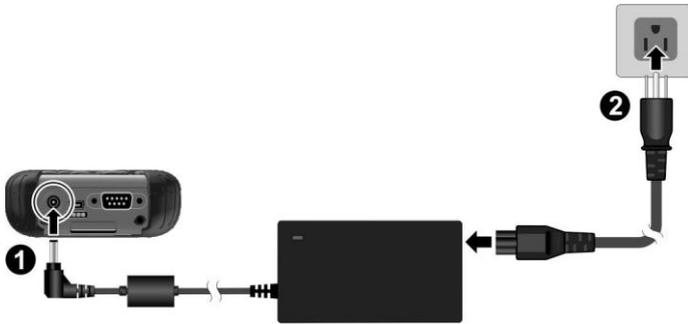
3. L'indicateur de charge s'allume en orange lorsque la charge est en cours. Ne déconnectez pas votre appareil de l'alimentation secteur avant que la batterie ne soit pleinement rechargée, ce qui est le cas lorsque l'indicateur orange prend une couleur verte. Cela devrait prendre deux heures environ.
